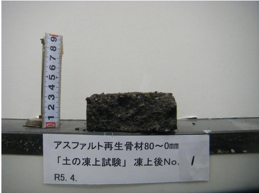
アスファルト再生骨材80~0mm
